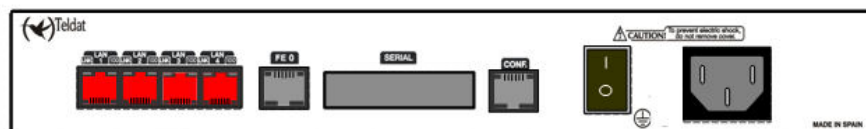
Fig. 6: T200 4 port Switch (LAN)
